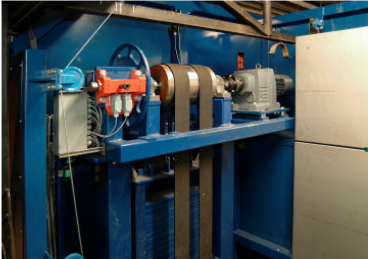
Antriebsstation mit Getriebemotor, Kupplung, Antriebstrommel und Verriegelung
