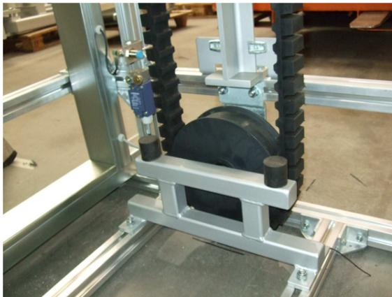
Untere Umlenkeinheit mit Schaltgeräten
