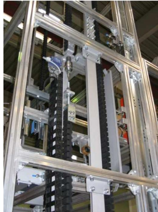
Ansicht Führungsschienen, Hubkonsole, Energiekette und Kettenbruchüberwachung
