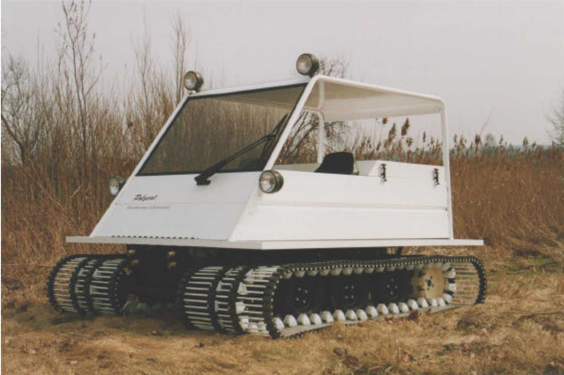
Beispiel einer Anwendung der Gummiblock-Kette als Fahrwerk.
